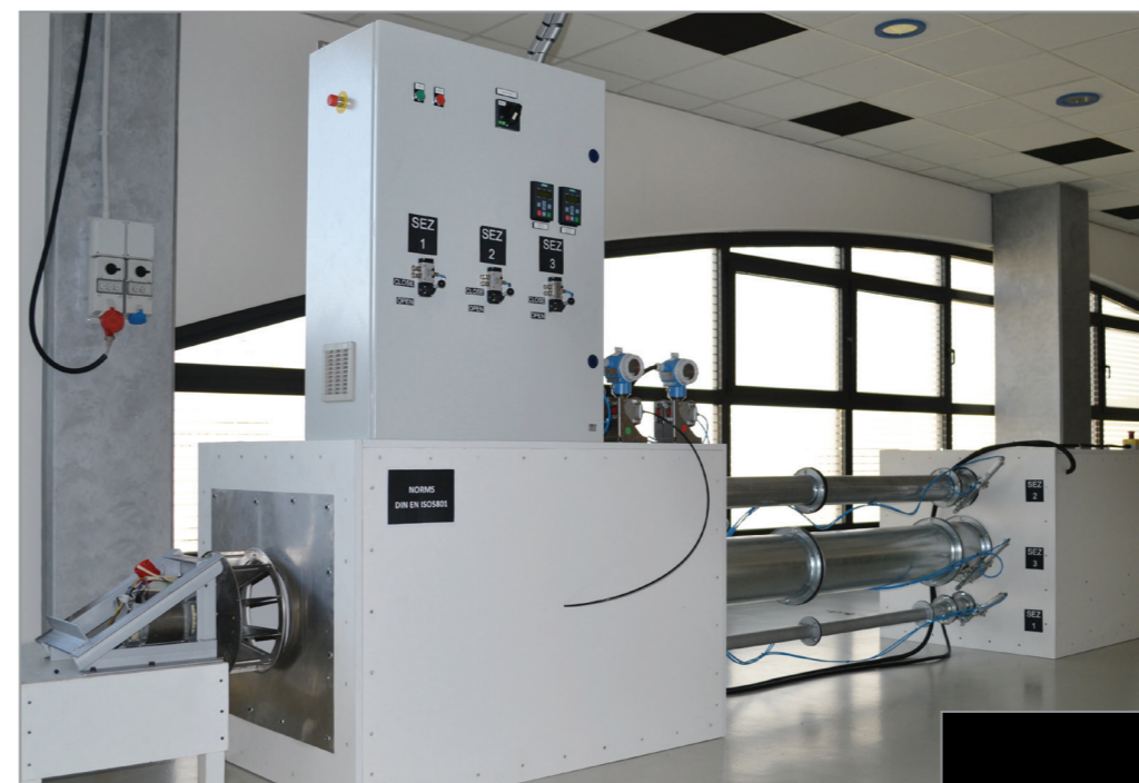
UNI EN ISO 5801に準拠したテスト機 Testing Machine norms UNI EN ISO 5801
